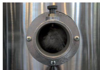
Sredinsko nameščena aluminijasta vtičnica premera 60 mm - možnost priklopa cevi fi 50 in fi 38 z kovinskimi ali plastičnimi manšetami.
