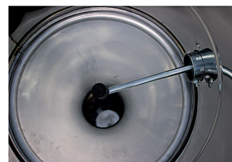
Ročni mehanski tresalnik filtra in kvaliteten, aluminijasti konus, ki poskrbita za zaščitno in sprotno vzdrževanje filtra.
