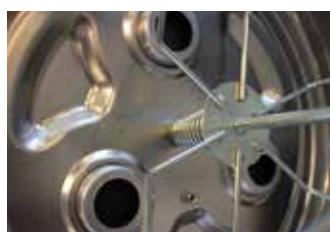
Z ročnim, centralnim, mehanskim stresalnikom filtra za optimalno stresanje filtra z veliko površino in odpornostjo na do Art. 7282
