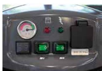
Na kovinski glavi so nameščena stikala za vklop posameznega motorja, merilnik podtlaka, dodatna vtičnica (brez Telekontrola), in signalizatorja vklopa/izklopa ter zasičenosti filtra.
