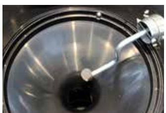
Ročni mehanski tresalnik filtra in kvaliteten, plastičen konus, ki poskrbita za zaščitno in sprotno vzdrževanje filtra.
