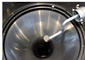
Sistema interno scuotifiltro manuale e cono plastica opzionale Manual filter shaker internal system and optional plastic cone
