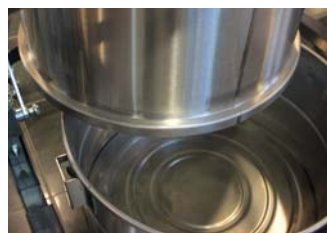
Sgancio rapido tanica raccolta Collection tank quick unhook system
