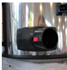
Ingresso polveri tangenziale plastica Tangential plastic inlet valve
