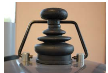
Scuotifiltro manuale superiore Manual filter shaker on top
